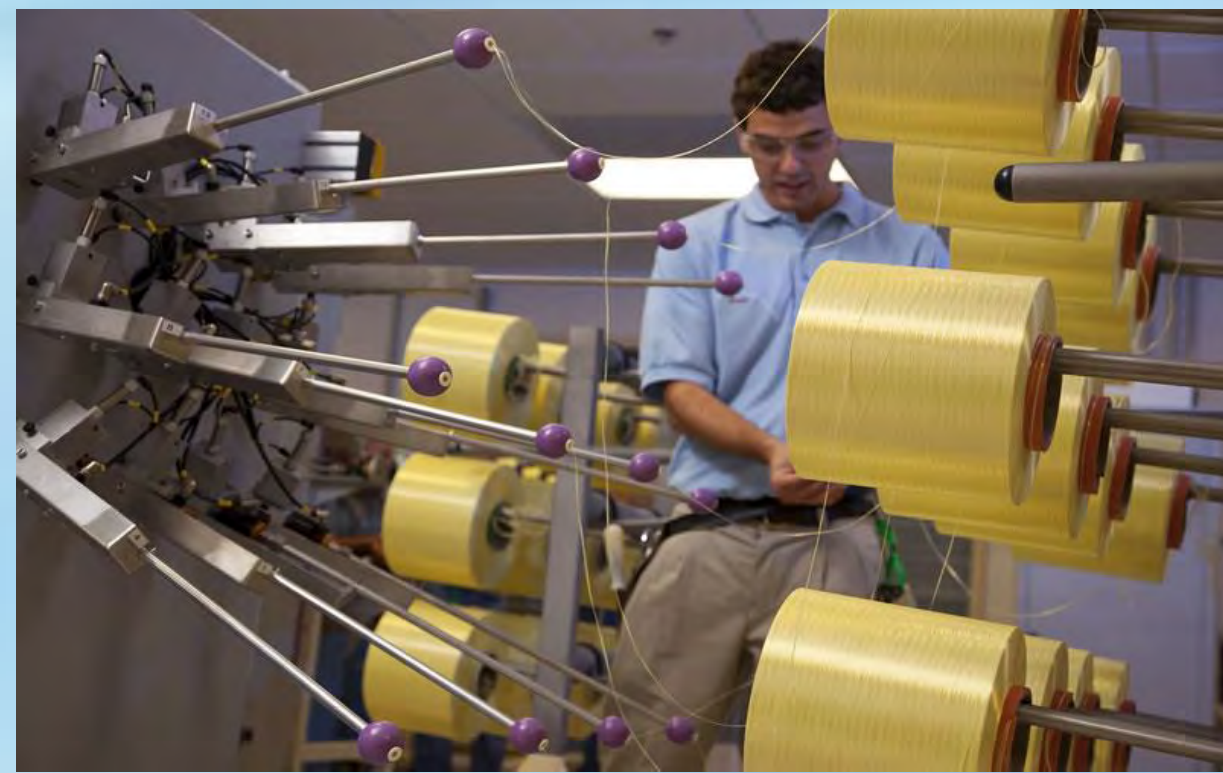
Şekil 5. Katmanlı Olarak Dokunabilir Elyaf Halinde Kevlar.
