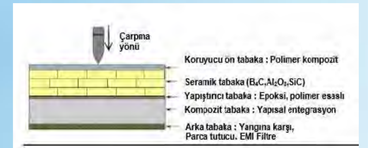
Şekil 12. Zırh Plakasının Genel Mekanizması.
