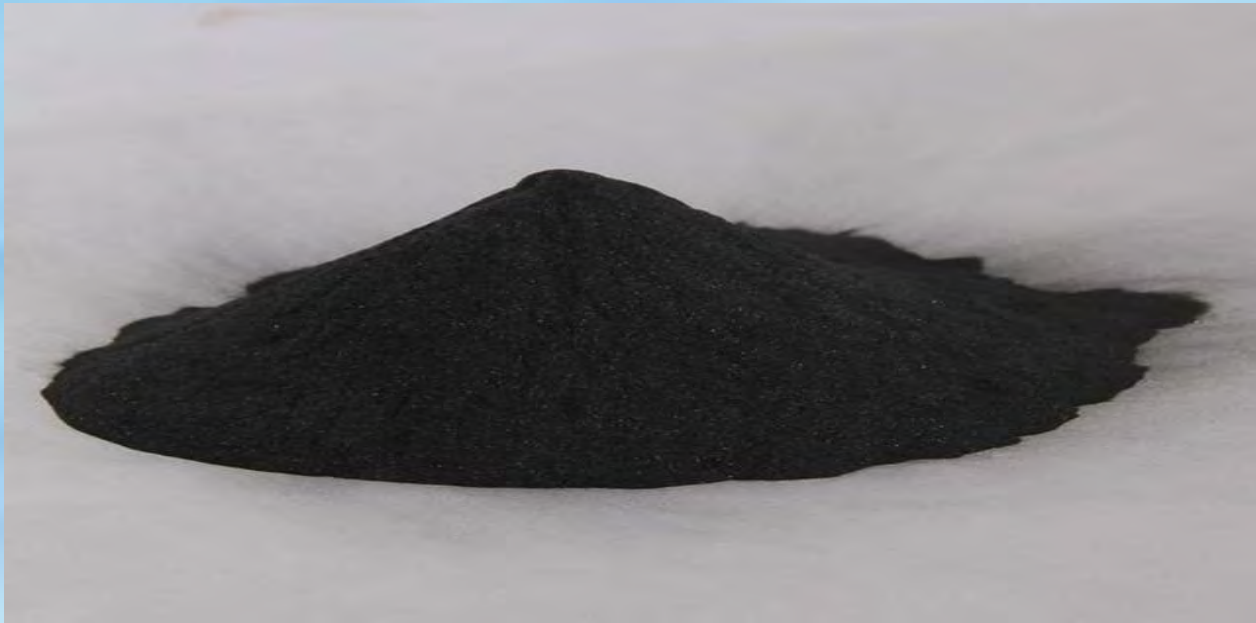
Şekil 9. Toz Halinde Elde Edilmiş Bor Karbür (B 4 C).
