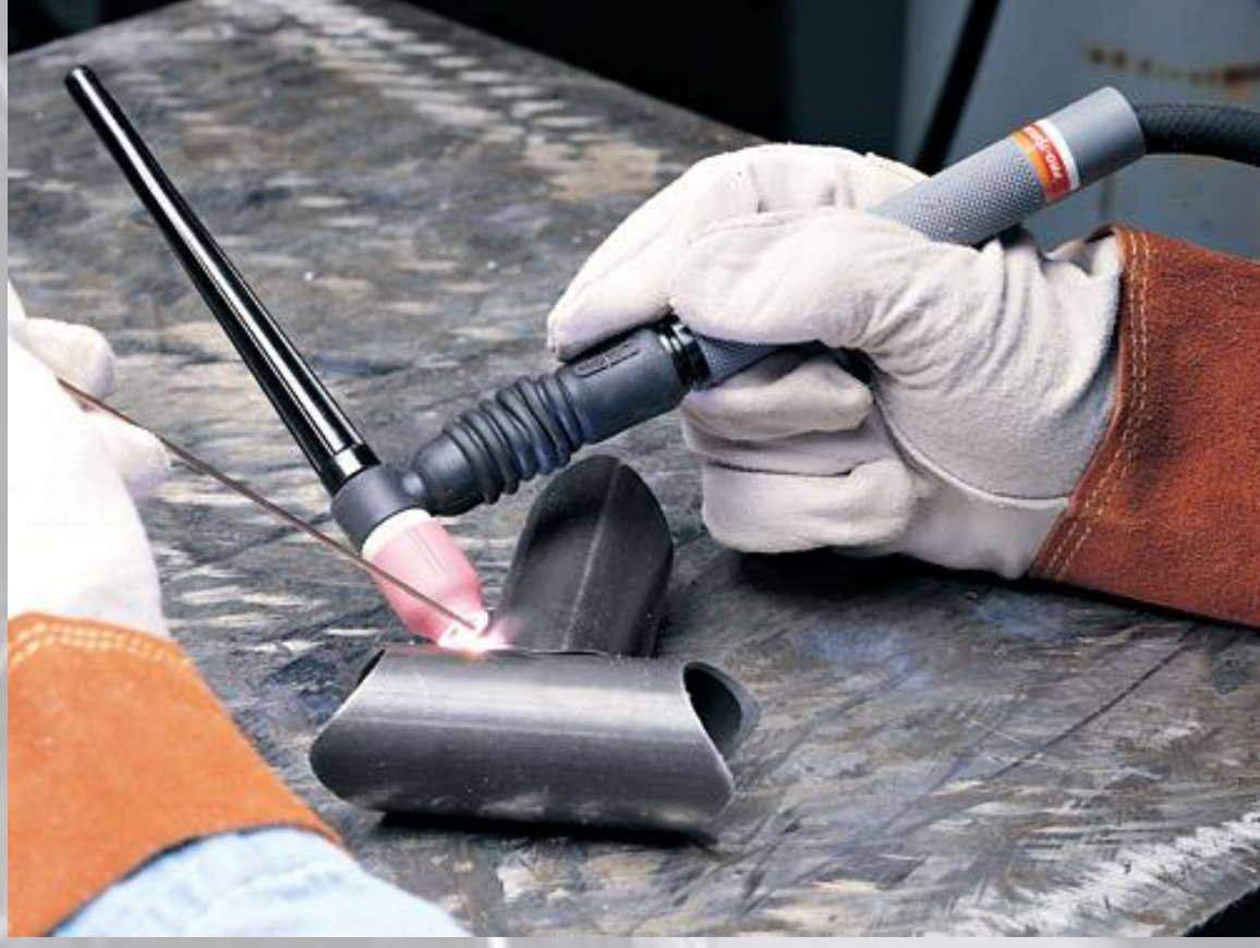
Resim 3: TIG yöntemiyle Mg profil birleştirme işlemi
